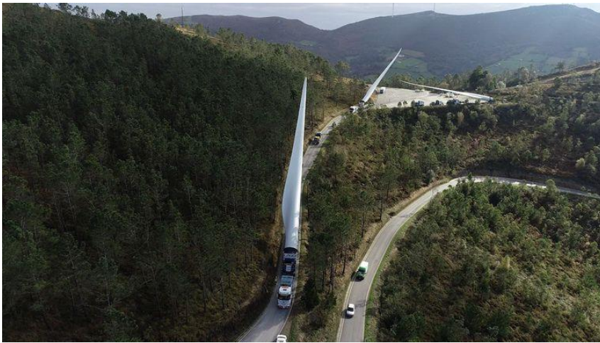
Traslado de palas del parque eólico de Buseco en Asturias CAPITAL ENERGY
