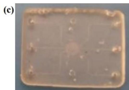
(a) Molde para el chip de PDMS fabricado en SU-8 sobre sustrato PCB. (b) Encapsulado en PLA empleado para que el chip de PDMS se fabrique con las dimensiones adecuadas. (c) Chip microfluídico fabricado en PDMS.
