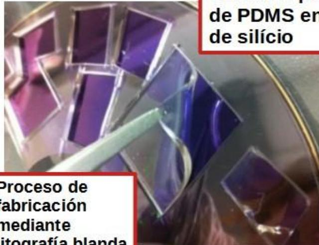
Proceso de fabricación mediante litografía blanda
