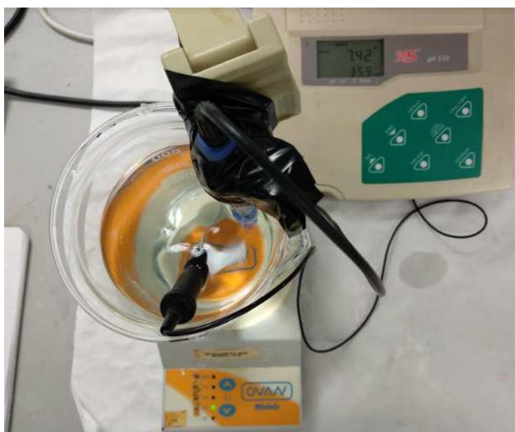
Figura 28. pHmetro utilizado para ajustar el pH durante el proceso de elaboración del SBF
