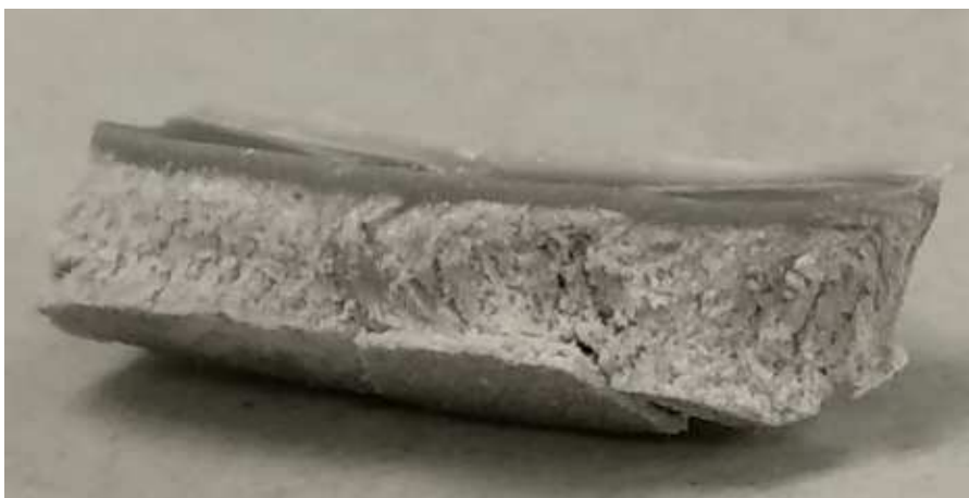
Figura 14. Detalle de la sección transversal de la muestra de PCL/GO (0,1%)
