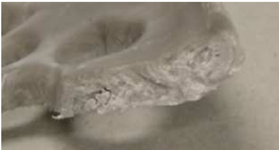
Figura 13. Detalle de la sección transversal de la muestra de PCL/GO (0,05%)
