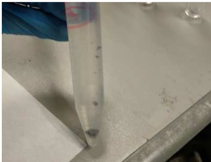
Figura 23. PCL/GO (0,1) sumergido en SBF. Puede observarse claramente la fragmentación de la muestra.
