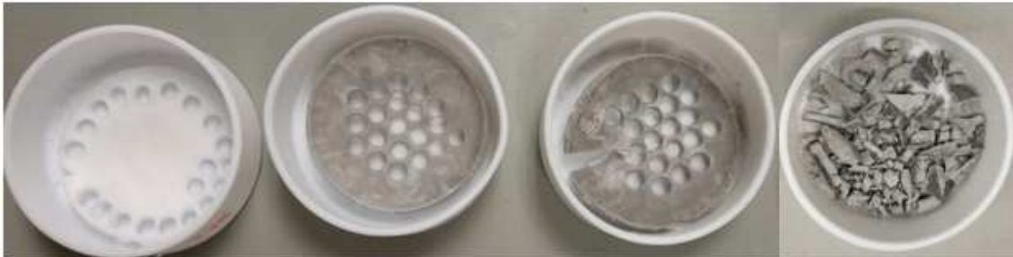
Figura 15. Las cuatro muestras una vez troqueladas. De izquierda a derecha: PCL, PCL/GO (0,03), PCL/GO (0,05), PCL/GO (0,1)
