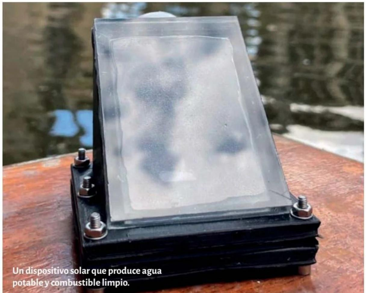
Un dispositivo solar que produce agua potable y combustible limpio.
