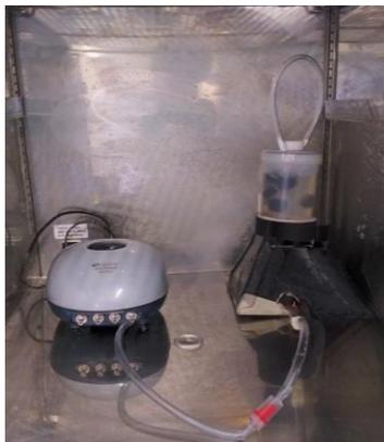
**Ilustración 13.** Montaje del reactor con los discos de hidrogel Gelatina-GO
