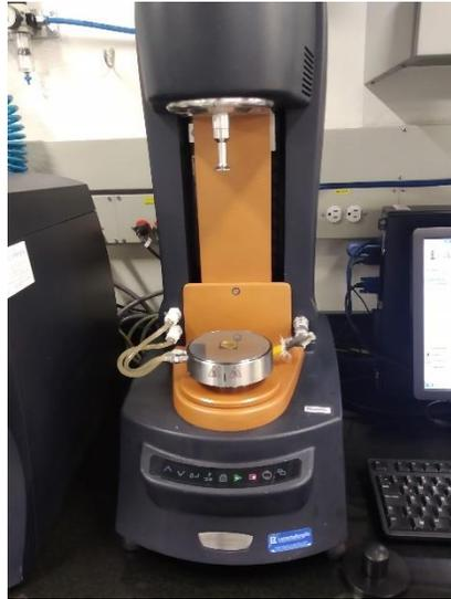
**Ilustración 10.** Test reométrico de platos paralelos.
